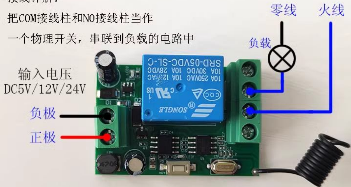
控制 220V 或其他电压的负载接线示意图
