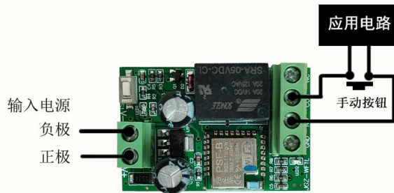
JGZ-WF1L 无源输出 控制手动开关接线图
