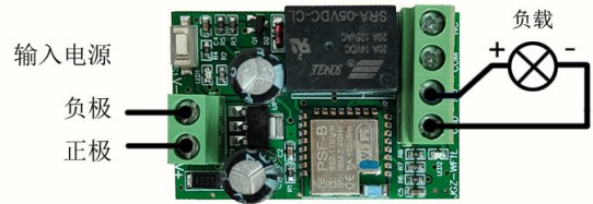
JGZ-WF1L 有源输出 接线图 输出电压=输入电压
